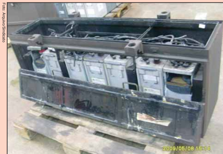
Baterias de trem após explosão espontânea no PIT
